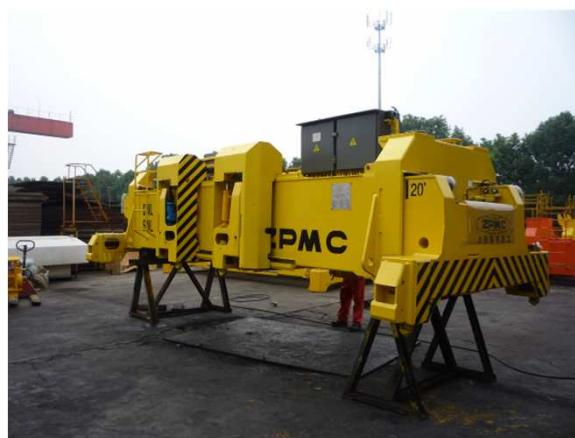
绿色环保概念是近年来港机发展的一个追求，ZPMC在绿色港机方面作了重要的研究和尝试，全电动集装箱吊具的推出，就是这一环保理念的重要体现，目前的全电动吊具品种包括轮胎吊、轨道吊吊具、门机吊具、岸桥吊具等，有单箱、双箱、旋转等多种型号。
