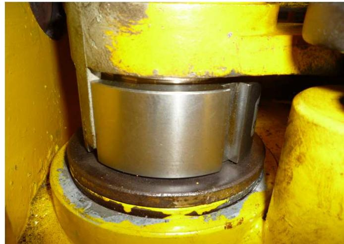
集装箱称重系统的研究，我们有意将超载保护、计量称重、防钩箱保护功能结合到吊具转销称重装置中，目前与两家德国传感器公司和一家中国公司合作，力图甄选出更加可靠的称重元件用于ZPMC吊具，已经装配一台吊具和三台上架在码头使用。
