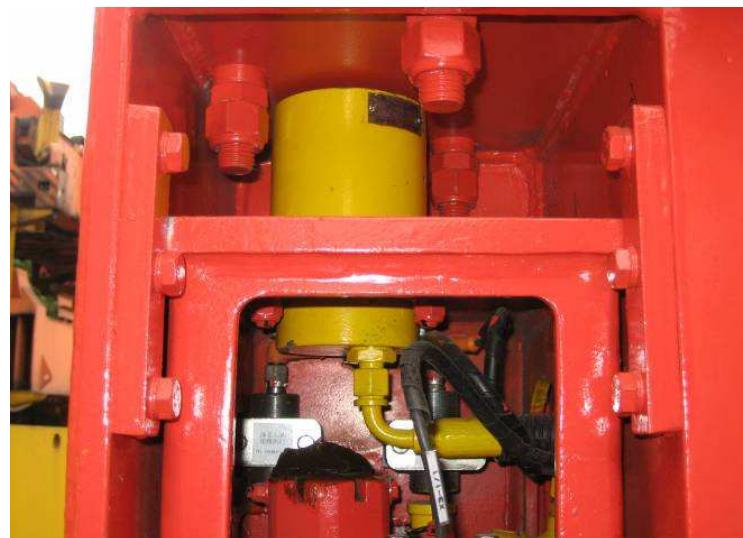
吊具减震是提高吊具钢结构使用寿命、减轻吊具自重的重要命题，我们曾经制作过用橡胶缓冲器进行端梁减震，并将他装在吊具上进行使用，结果发现，这种方案存在橡胶老化、能量不能被吸收等问题；我们设计了带储能和阻尼功能的液压减震装置，试验证明可减少冲击50%以上，目前正在做进一步的耐久试验。
