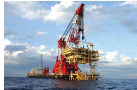
2008 – завершено строительство самого большого полностью поворотного самоходного плавкрана «Lan Jing» грузоподъемностью 7 500т.
